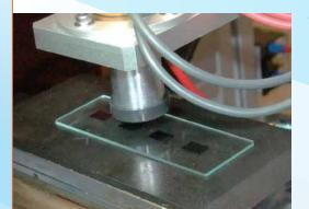
產品: 超薄半導體集成電路晶片管芯焊接超聲技術
